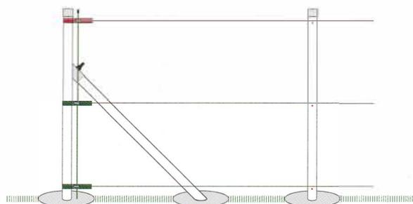
Na stĺpik pomocou opasku prichytíme napínaky. V prípade, že sa jedná zároveň o začiatkový aj rohový stĺpik, na opasok pridáme aj očko na prichytenie druhého napínaku. Vyvrtáme diery v príslušných výškach stĺpikov a osadíme príchytky na napínací drôt
