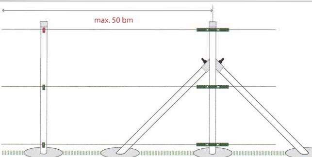
Keďže s jedným napínakom môžeme napnúť max. 50 m napínacieho drôtu, na zodpovedajúci stĺpik pripojíme obdobne napínaky a pomocou vidlicového kľúča vyšponujeme napínacie drôty. Po napnutí drôtov tieto zasunieme do príchytiek upevnených na stĺpikoch a dotlačíme háčik, ktorý je súčasťou príchytky. Toto nám zaisťuje stále napnutie napínacieho drôtu medzi stĺpikmi.
